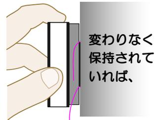
ノイズクリアの制振スパーサーは、テストピースの3倍の大きさで2つ使用するため、2.5~3.5kgの6倍=約15~21kgの保持力があります。
