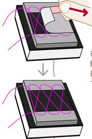
② クリーニングした壁の部分にテストピースを貼付け、**5秒間** 圧着します。
